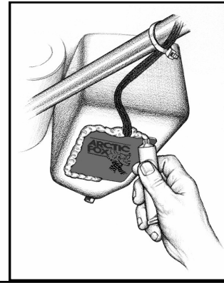
Fig. 3. Weatherproof the pad with silicone. Run cord to a convenient location. Figure 3. Mettre de la silicone autour du tampon pour le rendre étanche. Acheminer le cordon électrique vers un endroit pratique. Abb. 3. Heizdecke mit silikon wetterfest abdichten. Kabel zu einer gut zugänglichen Stelle führen Fig. 3. Een kitrand rond het element leggen en het aansluitsnoer naar een goed bereikbaar punt leiden.
